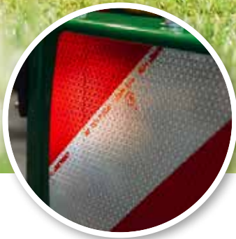
Reflektierende Warnfolie nach Norm (ECE-104)
