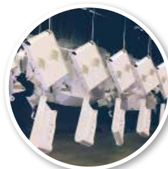
Alle Komponenten werden sandgestrahlt, grundiert und pulverbeschichtet. Erhältlich in allen RAL-Farben.
